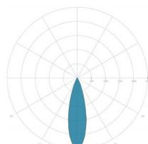
ÓPTICAS: 5-ROTOR SIMÉTRICA 20°
